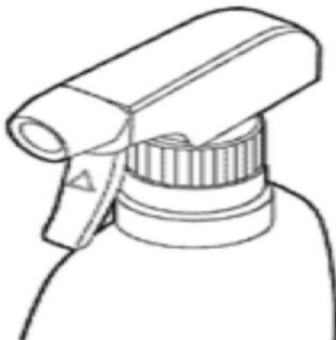
〈그림 2-23〉 레버 부분의 위험을 알리는 돌출 경고 표시
